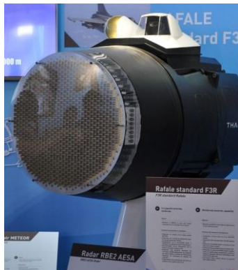
Figure 61 : Antenne radar à formation de faisceaux RBE2-AESA 181 pour l'avion de combat RAFALE – Thales DMS Figure 62 : Microcontrôleur spécialisé en formation de faisceaux d'antenne ADAR3000 – Analog Devices 182 Figure 63 : Antenne radar à formation de faisceaux pour la détection de missiles balistiques 183 . General Electric
