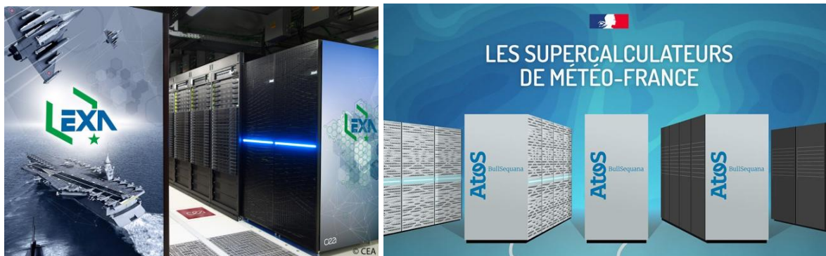
Figure 55 : A gauche : Calculateur EXA1 172 , partie du TGCC du CEA-DAM - 2021 - Puissance : 23 PFLOP Figure 56 : A droite : Calculateurs Belenos et Taranis 173 pour MétéoFR - 2021 - Puissance : 21 PFLOP
