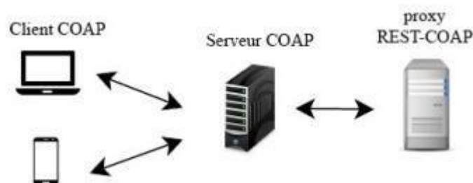
Figure 11 : Fonctionnement d'un CoAP
