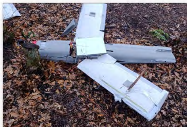
Image 24 : Drone Molniya abattu avec sa console Starlink
