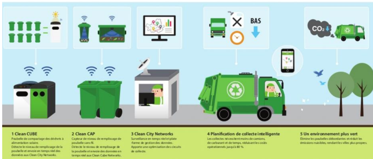
Figure 12 : Solution de collecte intelligente des déchets (Ecube Labs)
